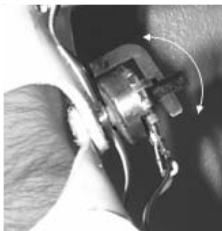
Figura 3: montagem do potenciômetro. As setas indicam a direção do desvio rádio-ulnar.
