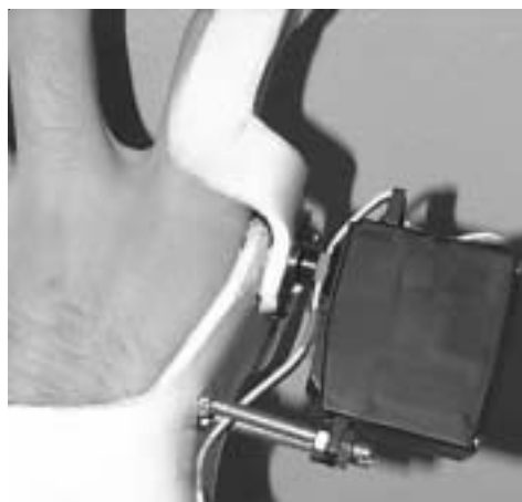
Figura 2: esquema de atuação via acoplamento direto ( direct drive ).
